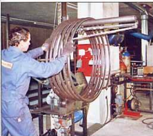
Auch die Herstellung der Glattrohrwärmetauscher erfolgt maschinell mittels Kaltbiegung, wobei bis 48 m Rohr in einem Arbeitsgang verarbeitet werden können.
