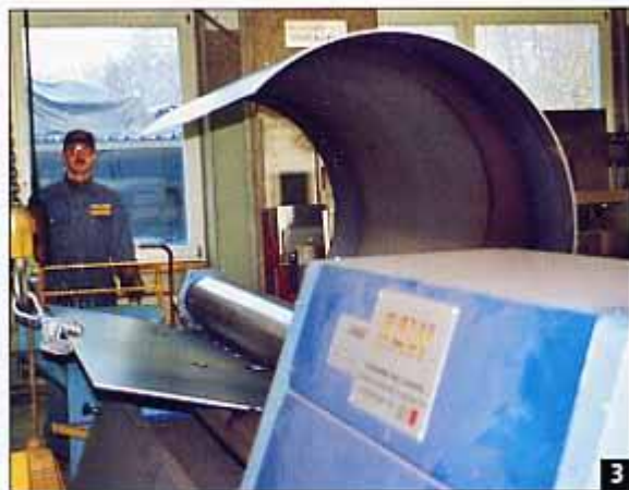
1 Die Speicherproduktion erfolgt direkt ab Blechcoil ... 2... für die Lochherstellung steht ein computergesteuertes Brenngerät im Einsatz. 3 Das Walzen der Bleche zu Zylindern erfolgt rasch. 4 Die Arbeitsabläufe sind rationalisiert: während der Schweissautomat die Rundnähte ausführt, kann ein Mitarbeiter gleichzeitig Stützen einschweissen.
