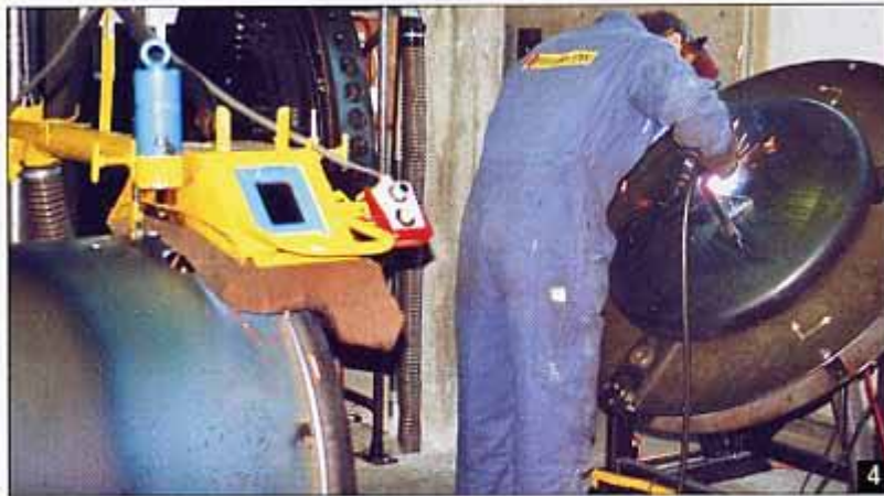
1 Die Speicherproduktion erfolgt direkt ab Blechcoil ... 2... für die Lochherstellung steht ein computergesteuertes Brenngerät im Einsatz. 3 Das Walzen der Bleche zu Zylindern erfolgt rasch. 4 Die Arbeitsabläufe sind rationalisiert: während der Schweissautomat die Rundnähte ausführt, kann ein Mitarbeiter gleichzeitig Stützen einschweissen.
