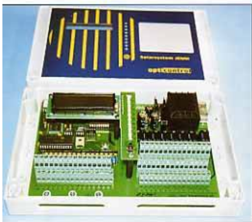
Das ist die neue Solarsteuerung Opticontrol. Oben: Bedienungsoberfläche, unten: elektronische Innereien. Alle Fotos: Franz Stohler.
